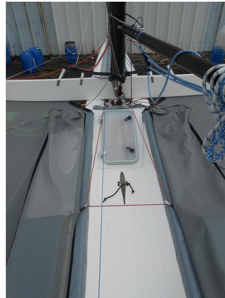
C'est un petit gain de raideur pour la coque centrale, une meilleure accesibilité au "pic avant" et une étanchéité garantie
