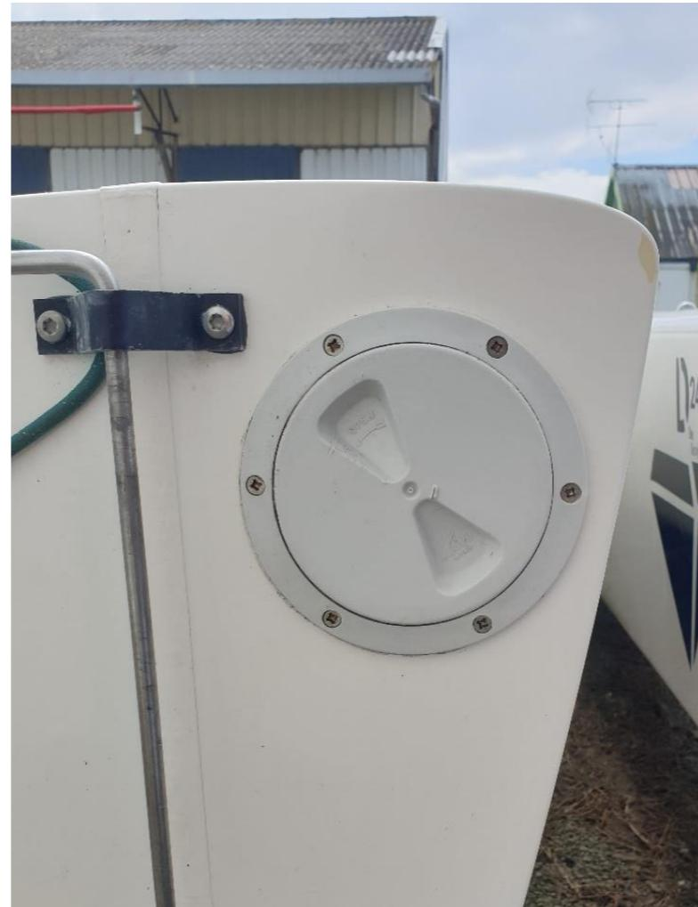
Pour répondre aux rares problèmes de non-étanchéité des flotteurs et à la demande de certains propriétaires, nous proposons le rajout d'une trappe de visite à l'arrière des flotteurs. Une trappe est mieux adaptée qu'un nable car elle permettra, à flot, de vérifier la présence d'eau ou pas.
