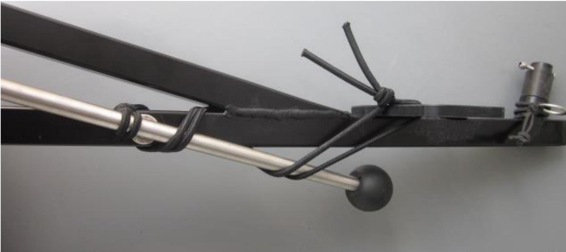
Afin de garder le safran toujours dans la même position lors de la navigation, il est nécessaire d'avoir un sandow pour le fixer. Vous trouverez ci-dessous la méthode pour en installer un si le votre est cassé ou décroché et la façon de l'accrocher en navigation.
