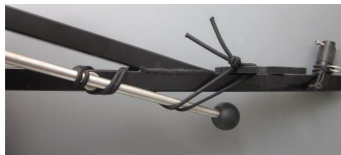
2. Puis bloquer le sandow dans le range stick. Le safran est bloqué en position basse quand la boule est positionnée dans la coupelle en acier fixé à la barre.
