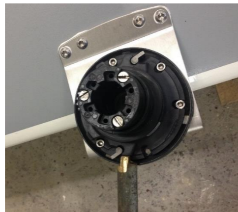
3. Pour supprimé ce « jour » et maintenir le cliquet dans son logement. Mettre en place le jet, de manière à appuyer sur la partie plate du logement
