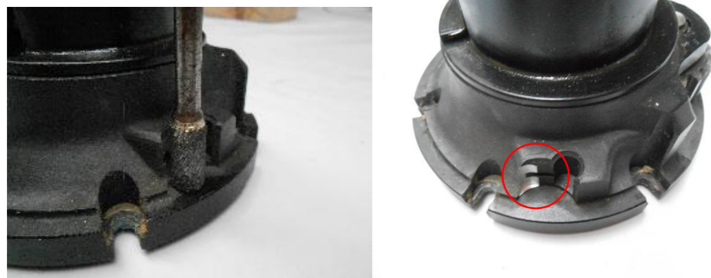
3. Pour supprimé ce « jour » et maintenir le cliquet dans son logement. Mettre en place le jet, de manière à appuyer sur la partie plate du logement
