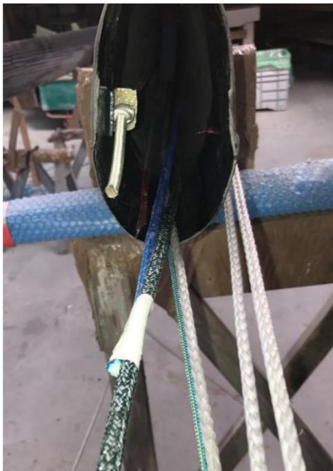
La drisse verte risque de ne pas être assez longue pour aller jusqu'en tête de mât. Il faut donc défaire la jonction en scotch, retirer la drisse verte en pied de mât, et rescotcher la drisse bleue sur la verte. On a ainsi suffisamment de longueur pour faire monter la nouvelle drisse en tête de mât.
