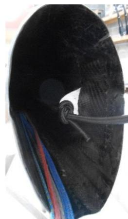
17. Passer l'extrême de la drisse à travers le pied de mât et le constrictor et faire un nœud d'arrêt.
