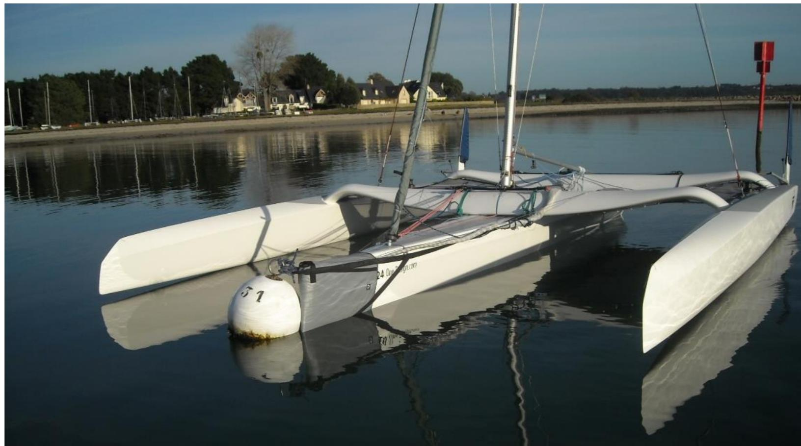
Le nez de mouillage permet de protéger la coque centrale du Diam24 lorsqu'il est amarré à un corps mort ou au mouillage. Il sert aussi de point fixe d'amarrage. Ci-dessous l'explication de l'installation du nez de mouillage et du montage des mousquetons.
