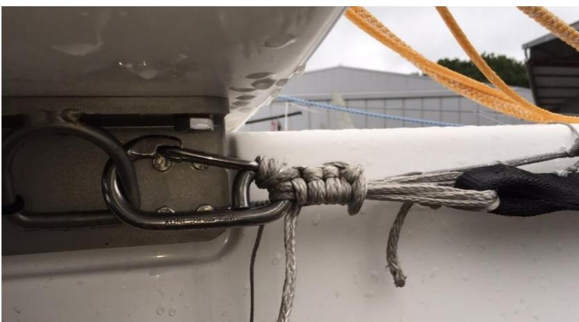
4. Pour terminer l'installation du nez de mouillage, on vient relier les 2 sangles par le petit bout et le crochet derrière l'étai.
