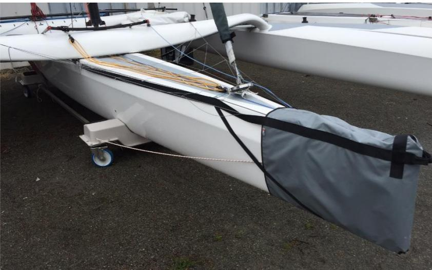
2. On vient accrocher les sangles qui reprennent les efforts sur les équerres de bras avant. Les sangles sont prolongées par un lashing en dyneema et un mousqueton « pompier ». On peut prérégler à terre la longueur des lashings pour que les mousquetons tombent parfaitement bien.
