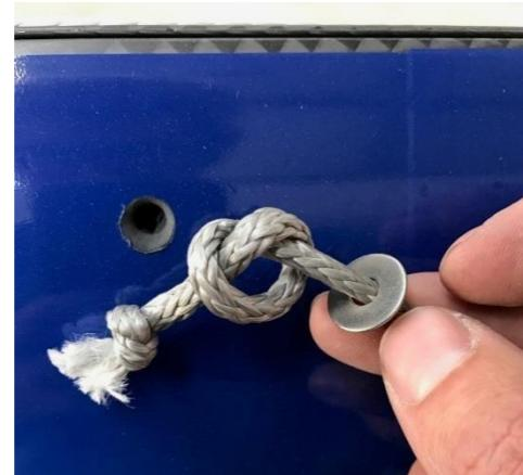
3. A l'aide de l'aiguille à chas ou d'un fil de fer passer le bout en dyneema à travers le mât et le faire ressortir de l'autre côté.
