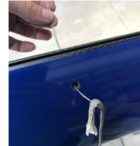
Attention à ne pas faire passer la drisse de GV entre le dyneema et la face arrière du mât, au risque de ne pas pouvoir déhooker la GV.
