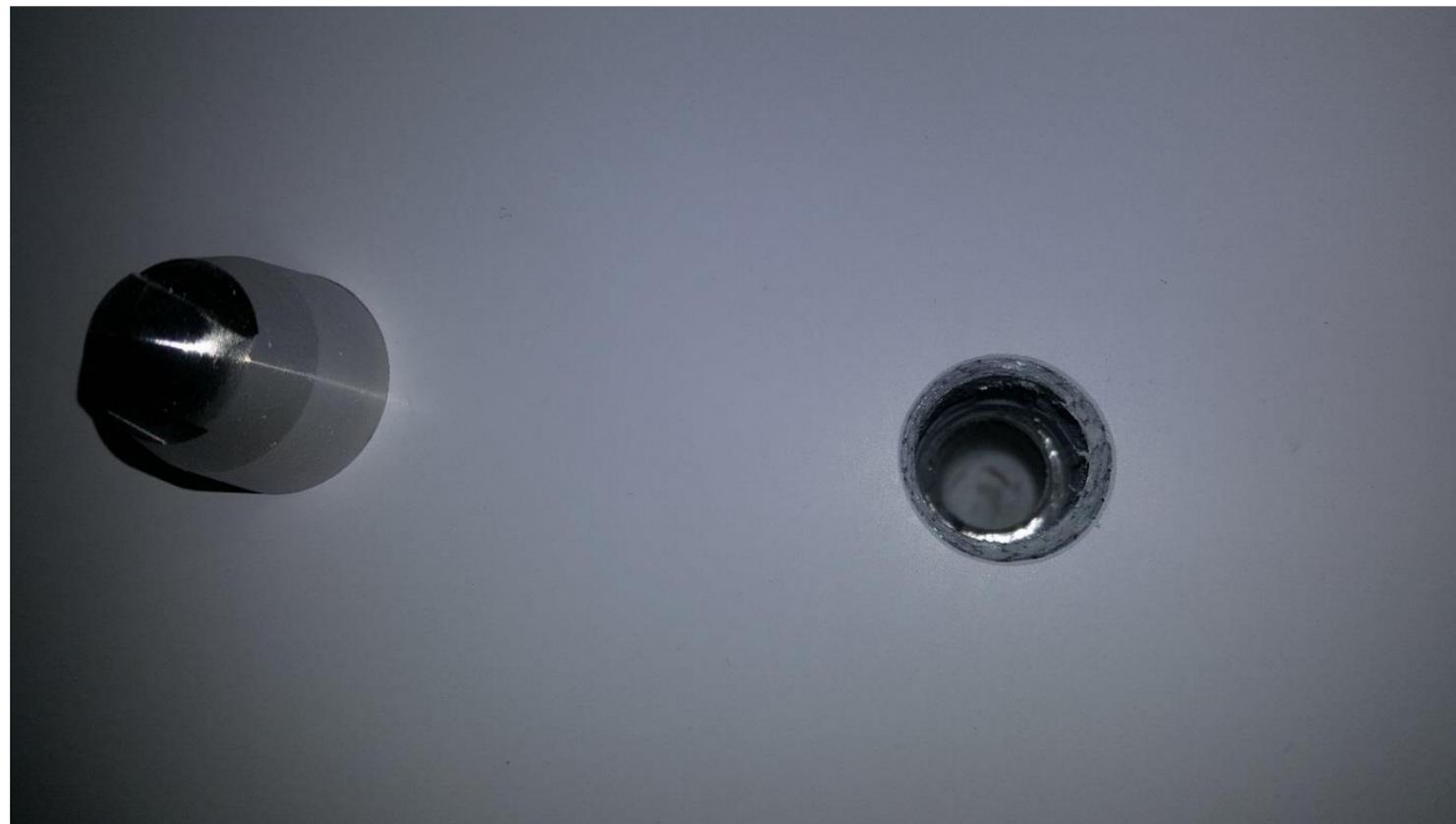
Dans le but d'assurer l'étanchéité des bras, il est parfois nécessaire de faire un joint silicone au niveau des équerres pour empêcher l'eau de s'infiltrer par le boulon. En effet, les boulons de fixation sur les équerres de la coque centrale sont vissés sur une pièce en inox, dites le sabot. Après effort, l'étanchéité entre la pièce en inox et le composite peut être dégradée, un joint en silicone est donc nécessaire. Nous allons vous expliquer comment faire.
