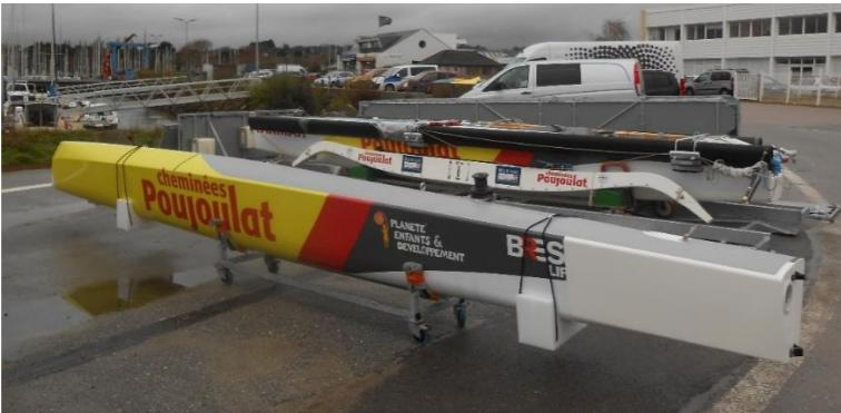
Placer les bers mousses sur les supports métalliques de la Dbox.
