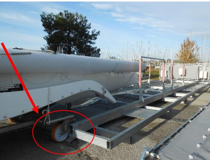
Une fois la coque centrale chargée, les roues avant de la MAO viennent se mettre en butée sur la marche et le nez du bateau dans le support en mousse.
