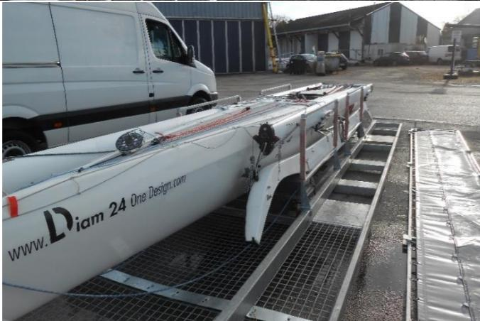
Une fois la coque centrale en place dans sa Dbox mettre les freins sur la remorque de mise à l'eau.
