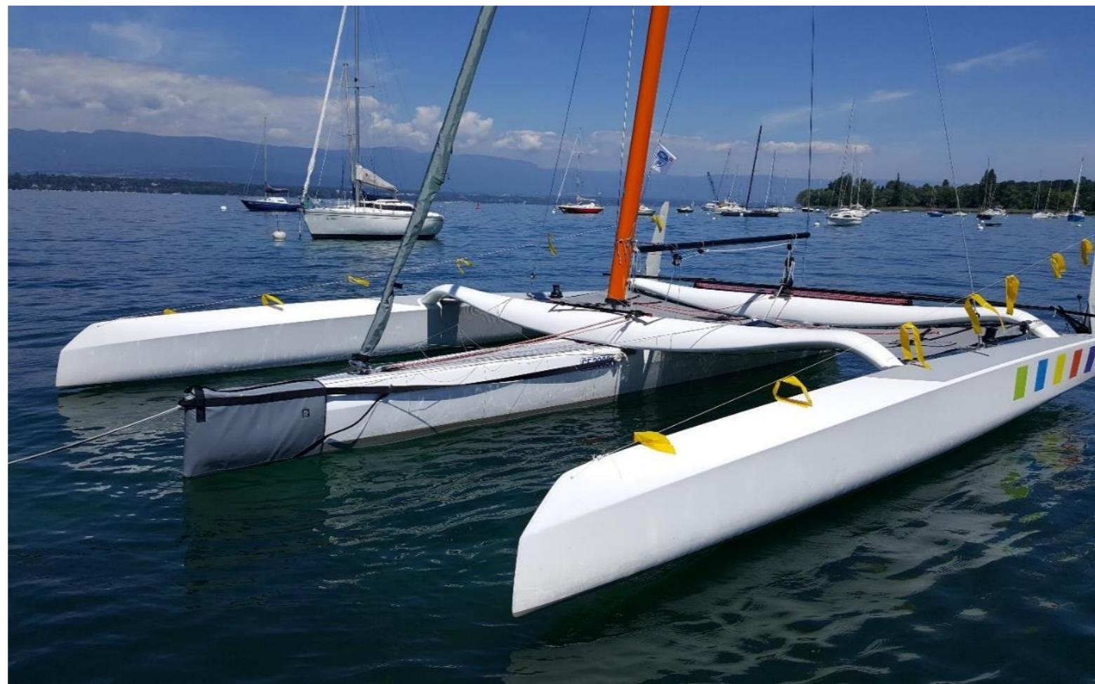
Pour ceux qui souhaite laisser leur bateau au mouillage il est important de protéger le gelcoat du développement de la faune et flore marine et du phénomène d'osmose par l'application d'un antifouling.
