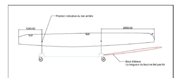
La MAO de cale doit être bien positionnée sur la coque Une flèche sur la coque centrale represente la position obligatoire du ber avant. Cette flèche est placée à 2850mm de l'étrave
