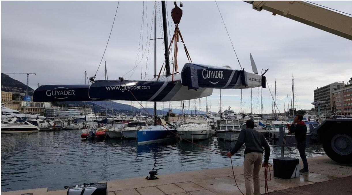
Remarque : Il est possible de gruter le bateau avec des bouts à la place des élingues. Si vous utilisez des bouts, il faut faire attention à ce que les bouts soient adaptés en charge et qu'il n'y ai pas de risque de coupure du bout. Une sangle par sa surface d'appui est mieux adaptée car elle diminue le risque d'effet « fil à couper le beurre » et de faire des dégâts sur le bateau.
