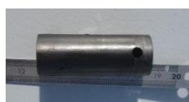
Bague à mettre dans la barre de liaison bord à bord des extrémités
