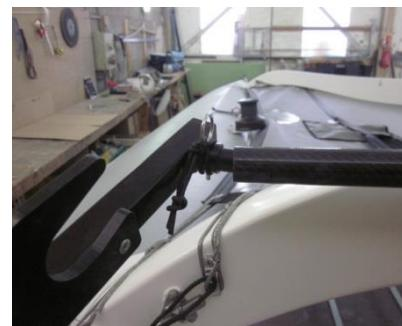
L'autre prend la mesure entre le tube et la barre de liaison.
