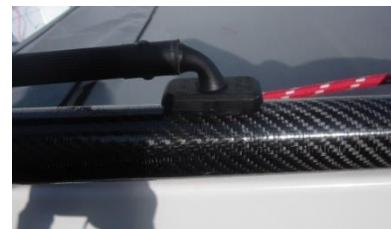
Percer avec le foret de 4 mm à 10 mm du bout de la barre de liaison (verticalement ou horizontalement)
