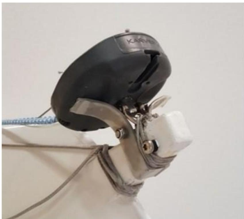
Correctif Technique : Chape d'emmagasinage de Gennaker, changement de la fixation au bateau
